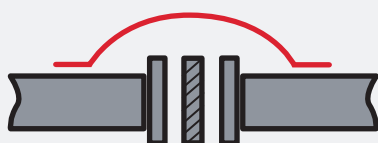
Uzemnění / přípojka kostry (příklad: potrubí)
