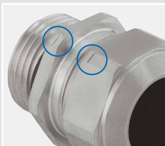
1 Rille kennzeichnet Stahl A2 . Dichteinsatz in TPE (schwarz)
